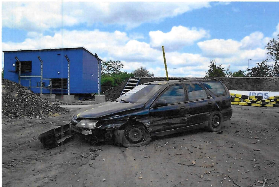
Rys. 3. Uszkodzenia pojazdu po kontakcie z barierą
